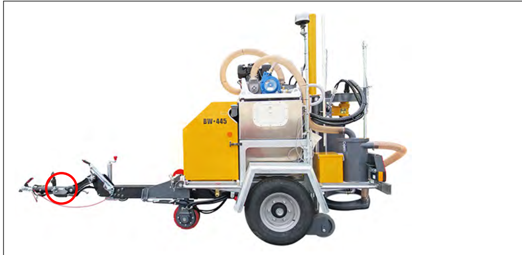
Lage des Typenschildes der Zugeinrichtung
