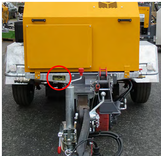
Lage des Typenschildes der Maschine
